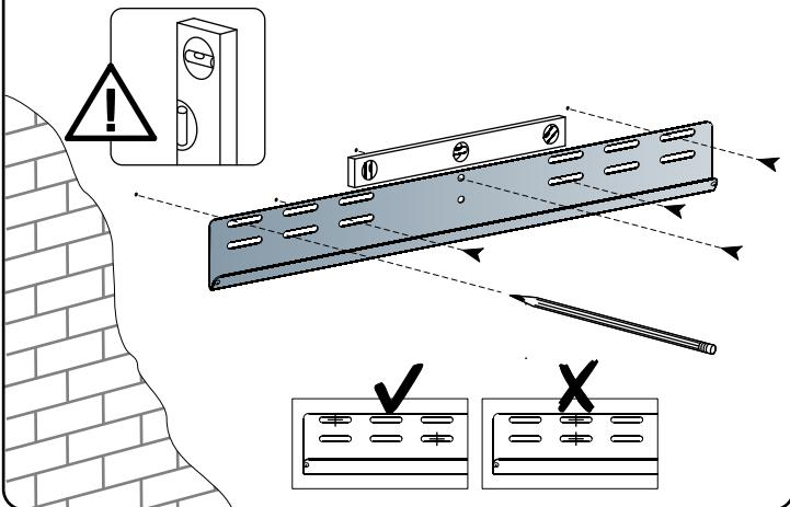
**2** Для более точной установки кронштейна предварительно просверлите в поверхности стены отверстия меньшего диаметра. После чего рассверлите отверстия сверлом Ø 12 мм и проверьте правильность их глубины.
